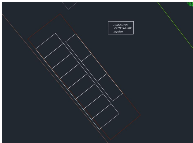
9. ábra Napelem elrendezés a 13-as parcellán elhelyezkedő közösségi épületen
